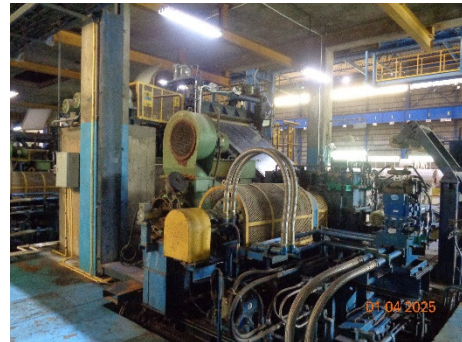
Guard ครอบส่วนที่เป็นอันตรายของเครื่องจักร
